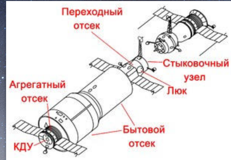
Схематичное изображение станции «Салют-1» и корабля «Союз»
